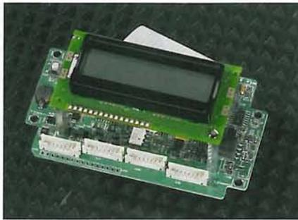
**Bild 3a:** Mit Hilfe der beschriebenen Optimierungsvorschläge konnte die anfänglich beidseitige SMD/THT-Bestückung reduziert werden...
